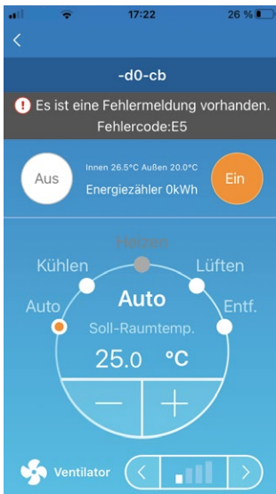
Abbildung 90: Fehlercode auf der Seite Übersicht Innengeräte
