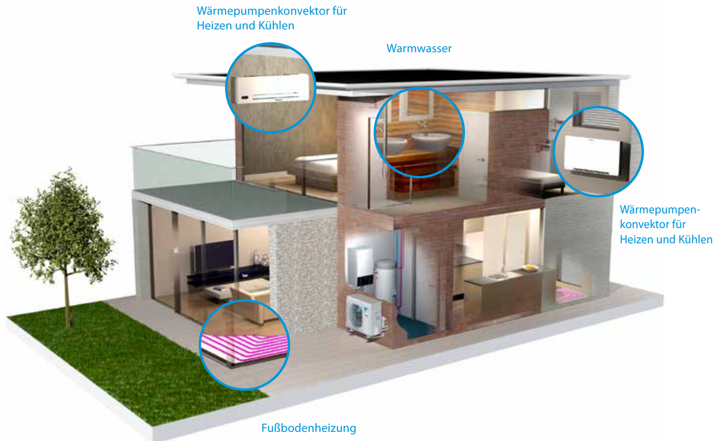
Beispiel einer Installation mit Warmwasserspeicher (EKHWS-D) aus Edelstahl
