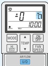
Das Display zeigt die eingestellte vertikale **Luftrichtung**.
